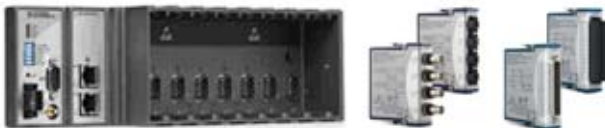
Fig. 5. cRIO-9074, NI 9229 and NI 9205 modules
